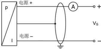
2-线制电流 (压力) / 3-线制 (温度)
