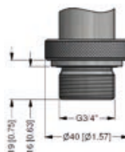
G3/4" semi-flush DIN 3852 (0.6 bar ≤ p N ≤ 60 bar gauge)
