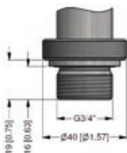
G3/4" flush DIN 3852 (0.1 bar ≤ p N ≤ 40 bar)
