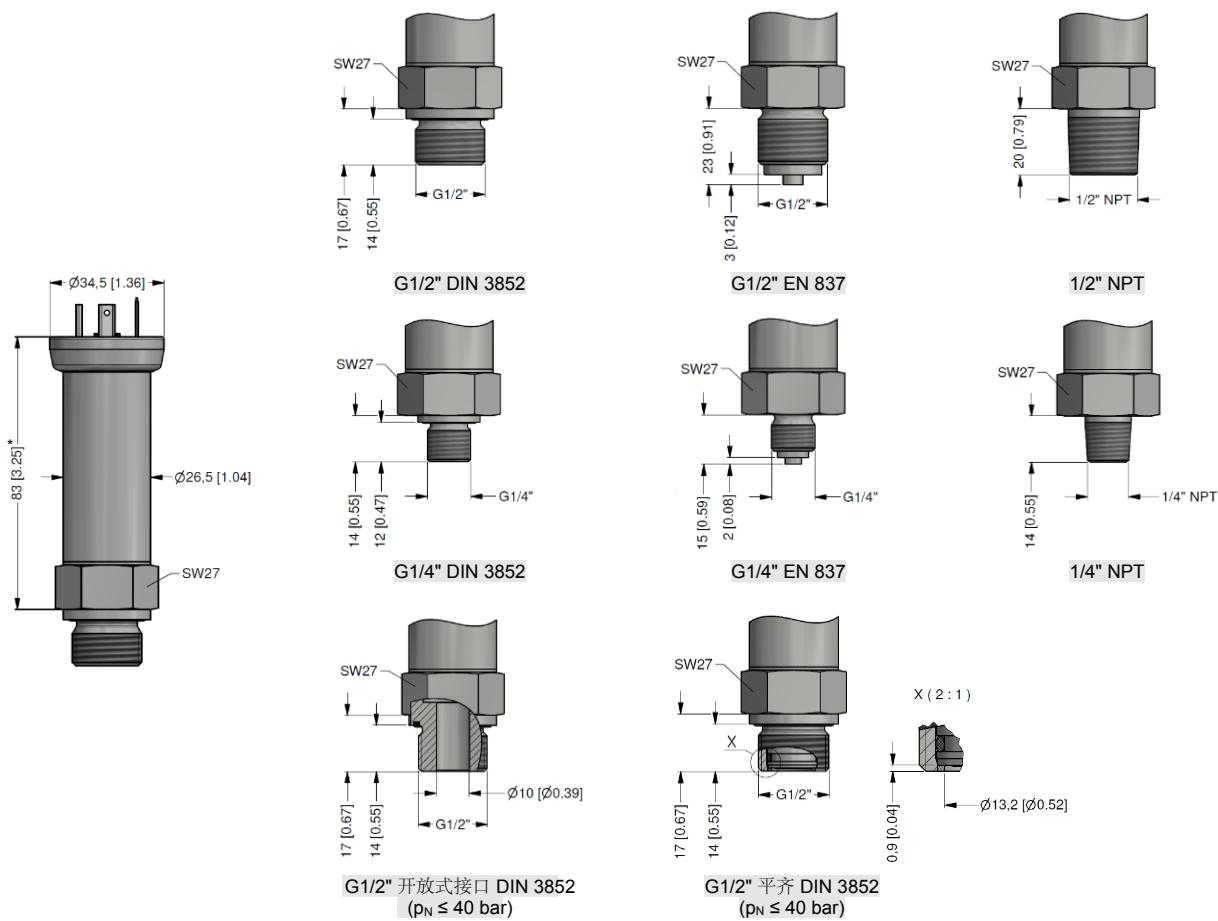
\*  $P_N \geq 100$  bar, 同时可选精度  $\leq \pm 0.25\%$  FSO BFSL : 产品总长增加 9 mm
